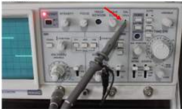
Gambar 5. 1. Menempatkan probe pada posisi kalibrasi
