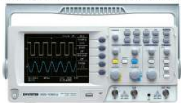
Gambar 3. 4. Bagian depan oscilloscope Digital
