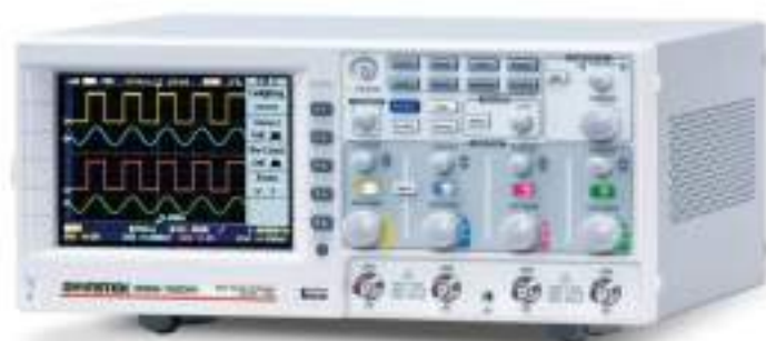
Gambar 2.2. Digital oscilloscope dengan 4 chanel
