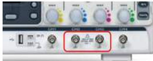
Gambar 2.4. Informasi tegangan maksimum yang diijinkan untuk diukur
