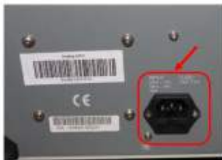
Gambar 4. 1. Informasi kebutuhan tegangan kerja pada oscilloscope
